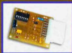
Блок зажигания — регулятор угла 03 на микроконтроллере PIC16F676.
