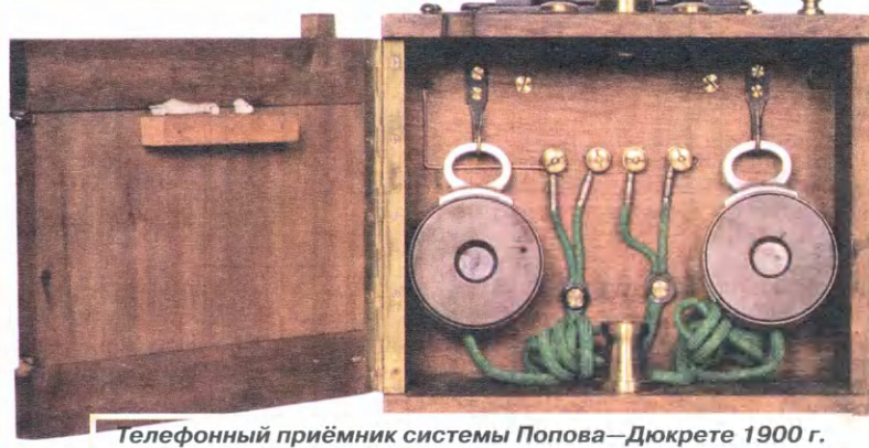
Телефонный приёмник системы Попова—Дюкрете 1900 г.
