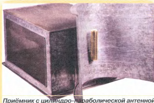
Приёмник с цилиндро-параболической антенной.
