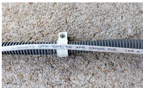
Рисунок 7. UTP-кабель, использованный для SVGA-удлинителя.
